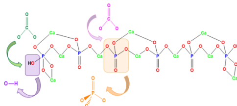
Fig. 1: Sustitución de carbonatos tipo A ( \text{CO}_3^{2-} \rightarrow \text{OH}^- ) y B ( \text{CO}_3^{2-} \rightarrow \text{PO}_4^{3-} ) en la estructura de HAp.
